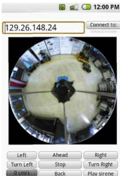
Fig. 9: USER INTERFACE OF TELEOPERATOR SOFTWARE IN THE ANDROID ENVIRONMENT.
